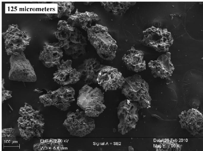
Figure 3. Vue au microscope électronique à balayage de la fraction la plus grossière (> 125 microns = 0.125 mm) des cendres recueillies en Guadeloupe. Il s'agit de ponces fortement vésiculées.
